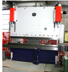
Hämmerle AP 200 Hoch präzise CNC- gesteuerte Dreipunkt- biegemaschine
